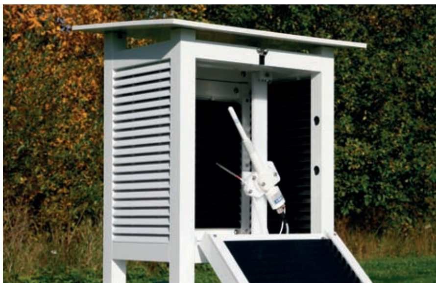
Die HMP155 mit neuem, stabilen HUMICAP®180R Sensor und zusätzlicher Temperatursonde
