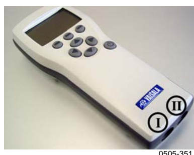
図 17 MI70 プローブとケーブルのコネクターポートの位置
