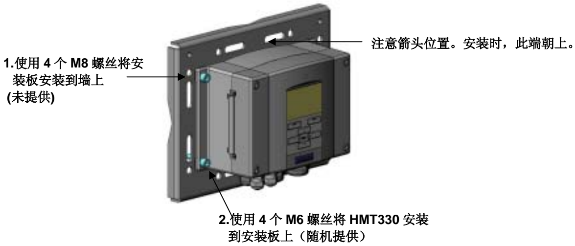
图 3-6 带金属安装板的安装
