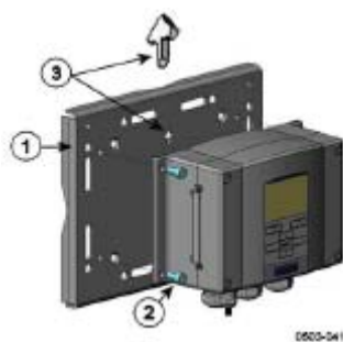
图11 采用金属壁装板安装
